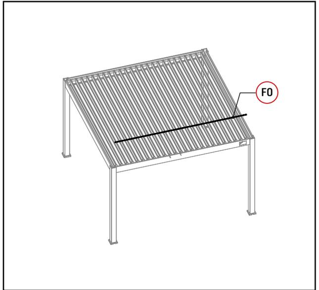
Schließen Sie die Verbindung der Lamellen mit dem FO-Teil ab.
