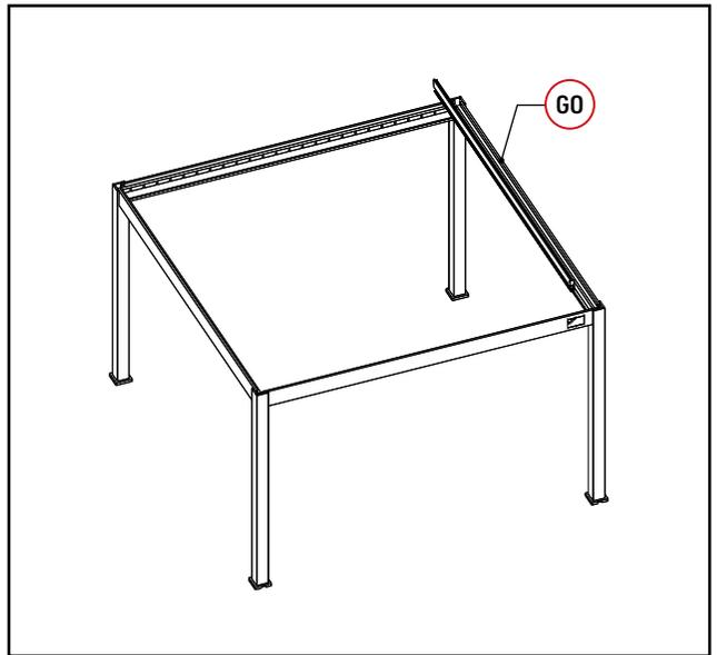
Installieren Sie denselben Lamellen auf dem Balken.
