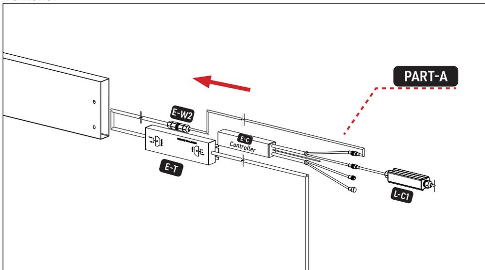
Das Kabel des Transformators verläuft durch den Pfosten und das Kabel tritt aus dem Ablauf aus. "EINGANG" verbinden Sie mit der Hausstromversorgung, "AUSGANG" verbinden Sie mit der LED.
