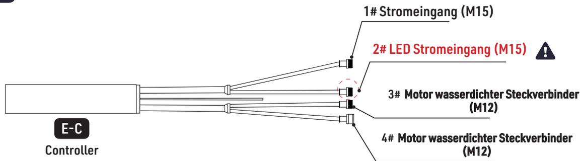
Schließen Sie zuerst den LED-Controller an den Transformator (TEIL-A) an und platzieren Sie ihn dann in der Aussparung des Balkens.
